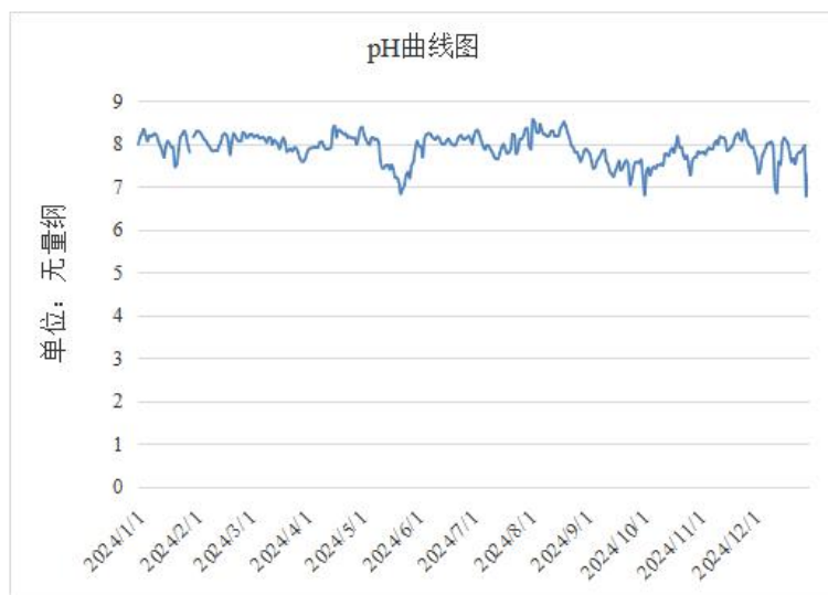
图 3.2.18-6 污水排放口 2024 年 pH 在线监测曲线
