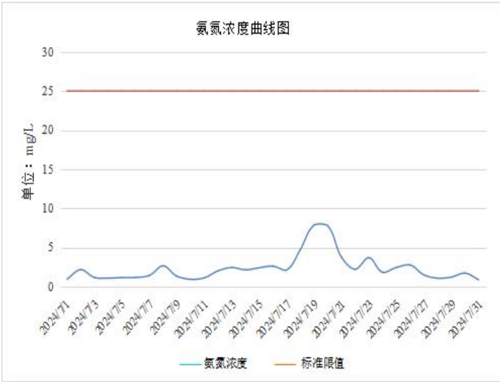
图 3.2.18-9 污水排放口 7 月氨氮在线监测曲线
