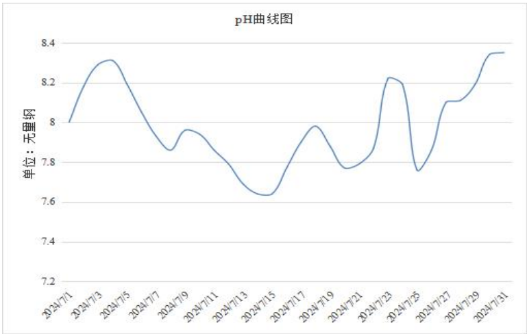
图 3.2.18-5 污水排放口 7 月 pH 在线监测曲线
