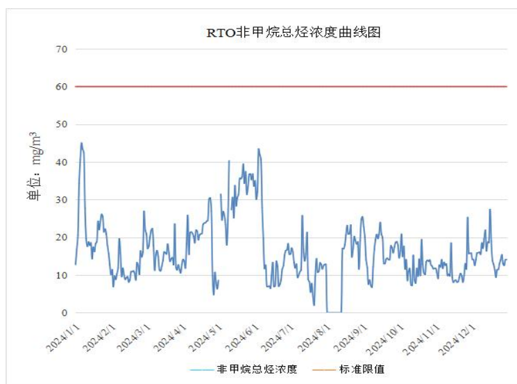
图 3.2.18-14 RTO 废气排放口 2024 年非甲烷总烃在线监测曲线
