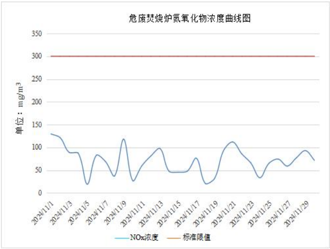
图 3.2.18-18 固废焚烧炉排放口 7 月 NO x 浓度（时均值）在线监控数据
