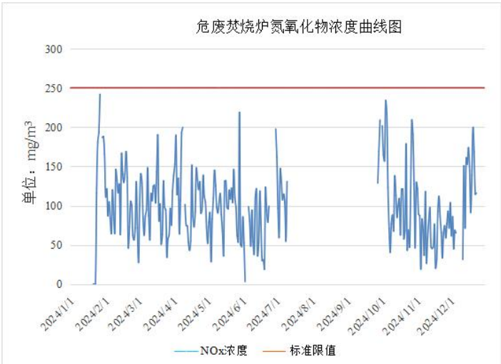
图 3.2.18-19 固废焚烧炉排放口 2024 年 NO x 浓度（日均值）在线监控数据
