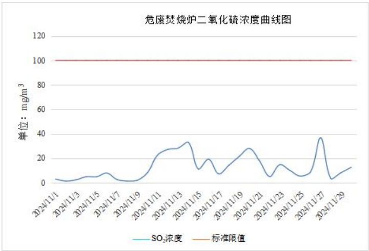
图 3.2.18-16 固废焚烧炉排放口 11 月 SO 2 浓度（时均值）在线监控数据
