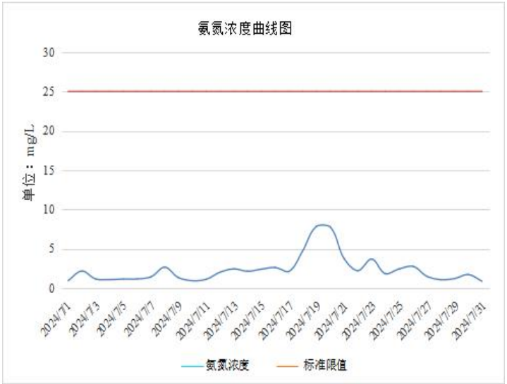
图 3.2.18-9 污水排放口 7 月氨氮在线监测曲线
