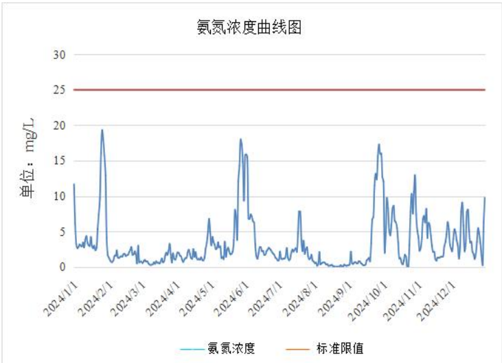
图 3.2.18-10 污水排放口 2024 年氨氮在线监测曲线
